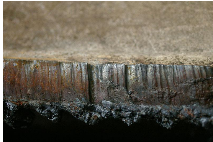
چاک ها در برش پلاسما در تزریق با اکسیژن
