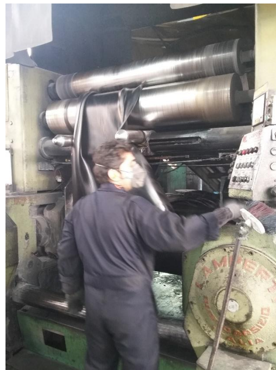
عبور مواد از غلتک در چندین مرحله برای تولید لقمه
