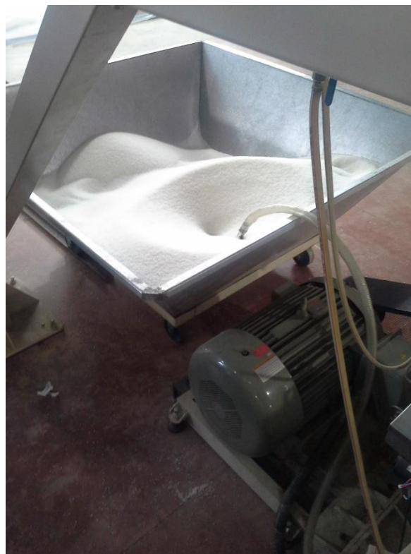
مکش مواد خام به درون قالب
